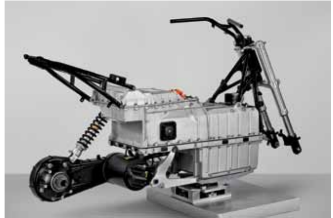
C-evolution, lado derecho del basculante al cual está amurado el motor
